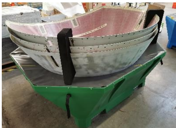
Caisses radôme assemblées chez Talendi pour le transport des nez d'avion.
