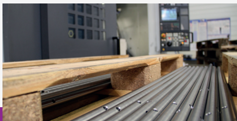
Usinage de Barres de contact catener pour le secteur ferroviaire
