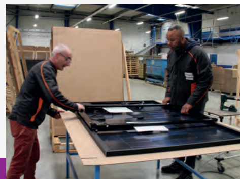
Reprise de câblage platines Électriques
