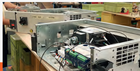
Assemblage et câblage de platines électriques
