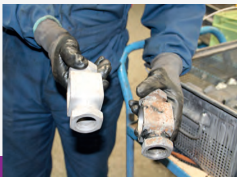
Maintenance de robinets pneumatiques
