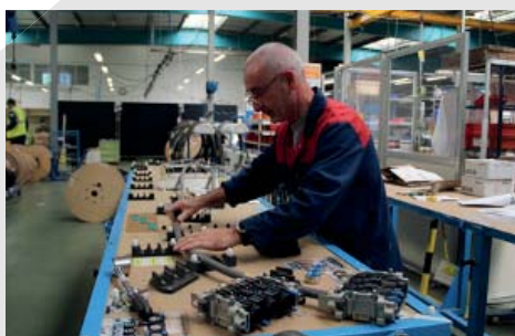
Montage Faisceaux câbles moteur ferroviaire
