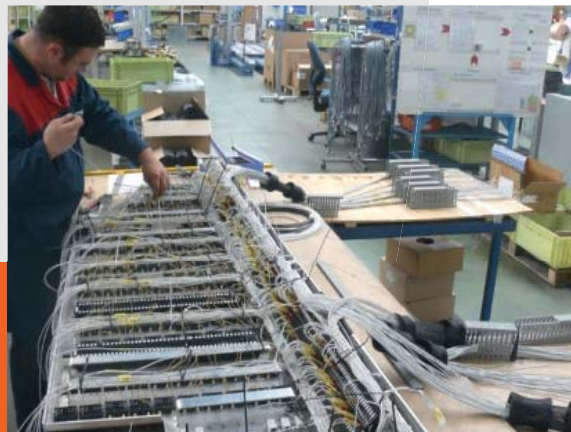
Platine électrique MI79. Assemblage de 1700 fils
