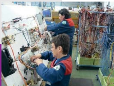
Assemblage de câbles pour réalisation de faisceaux
