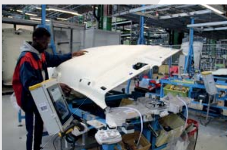
Montage de garnitures de pavillons pour l'automobile
