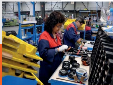
Montage de bobines de climatisation pour l'automobile
