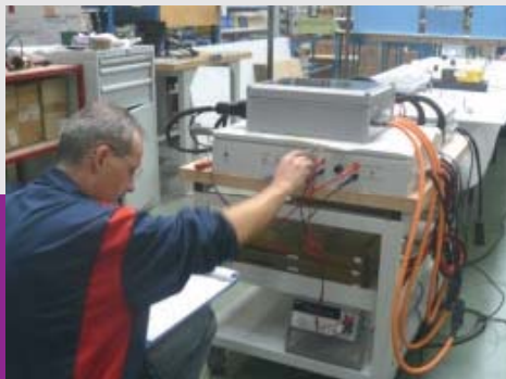
Test diélectrique sur boîtier embarqué pour véhicule électrique
