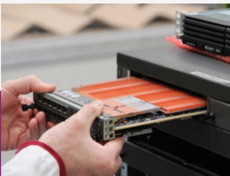
Intégration d'une carte MDA dans la baie informatique
