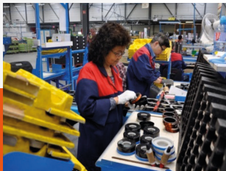
Montage de bobines de climatisation pour l'automobile
