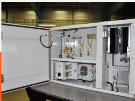
Armoire – Panneau de freins ferroviaire
