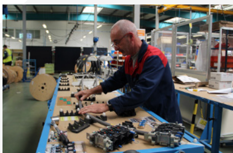
Montage Faisceaux câbles moteur ferroviaire
