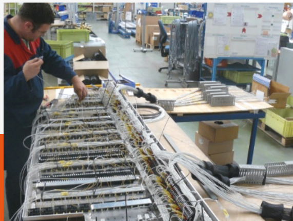
Platine électrique MI79. Assemblage de 1700 fils
