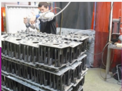
Ancrages pour ouvrages
