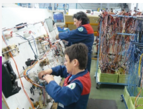
Assemblage de câbles pour réalisation de faisceaux
