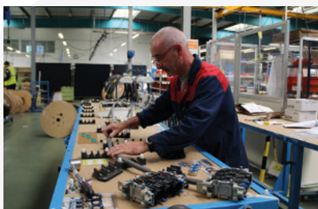
Montage Faisceaux câbles moteur ferroviaire
