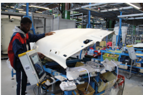
Montage de garnitures de pavillons pour l'automobile
