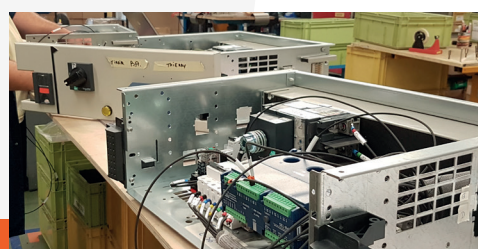
Assemblage et câblage de platines électriques
