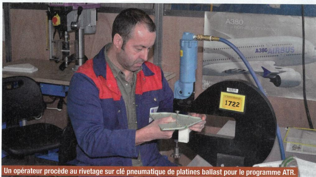
Un opérateur procède au rivetage sur clé pneumatique de platines ballast pour le programme ATR.
